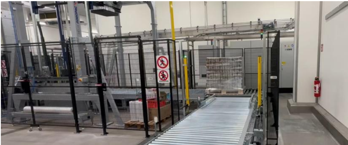
Paletten-Wicklung / Stretchen / Etikettierung der fertigen Palette
