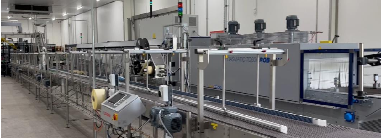
Tray-Verpackung mit großen Pufferstrecken
