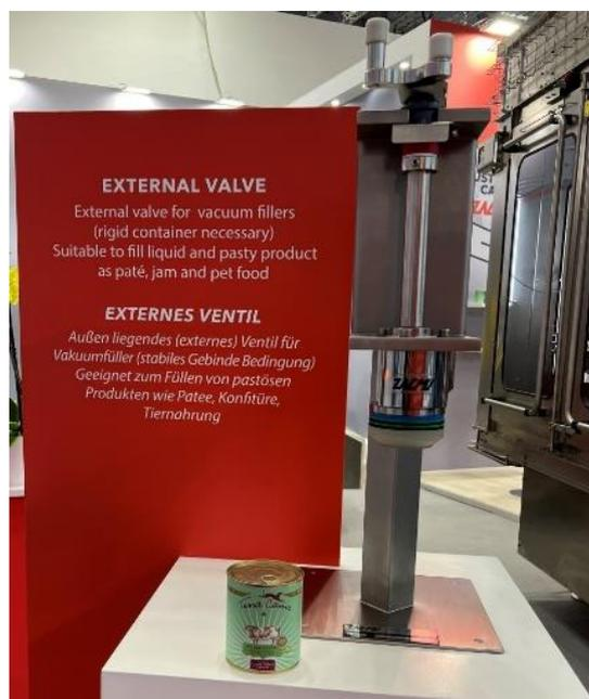
Beispiel eines extern (außen) angeordneten Füllventils am Vakuum Füller.
